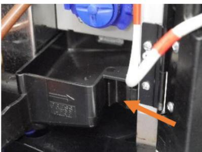
Drücken Sie die Lasche (s. Pfeil) zum entriegeln und entnehmen sie den schwarzen Düsenhalter, um ihn zu reinigen. Nach der Reinigung wieder einsetzen (auf Einrasten achten).
