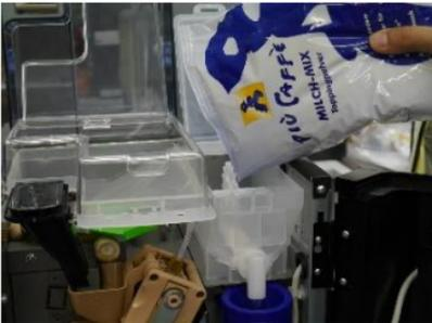
Füllen Sie das Milchpulver in den entsprechenden Behälter.
