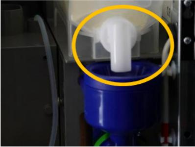
Prüfen Sie mit dem Finger den markierten Bereich auf Verschmutzung. Wenn nötig, drehen Sie den Milchausgabewinkel im Uhrzeigersinn und entnehmen Sie ihn zum Reinigen.
