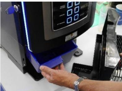
Entfernen Sie die Tropfschale. Leeren Sie ggf. den Satzbehälter (blau). Hinweis „Auffangschale einsetzen“ erscheint auf dem Display. Anschließend wieder einsetzen.
