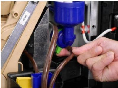
Drehen Sie den grünen Schieber gegen den Uhrzeigersinn und entnehmen Sie den blauen Trichter.
