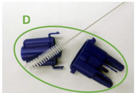
Nach der Reinigung alles wieder zusammenbauen und einsetzen.
