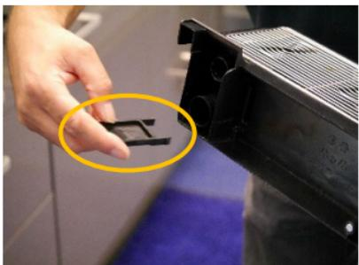
Satzbehälter und Tropfschale wieder einsetzen. Bei Tropfschale auf markiertes Teil achten (kann herausfallen).
