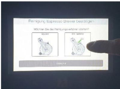
Zum Reinigen des „Espresso Brewer“ das Reinigungsverfahren „Mit Tablette“ auswählen.
