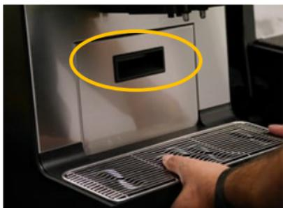
Entfernen Sie die Tropfschale und den Satzbehälter (an markiertem Griff entnehmen). Leeren Sie ggf. den Satzbehälter.
