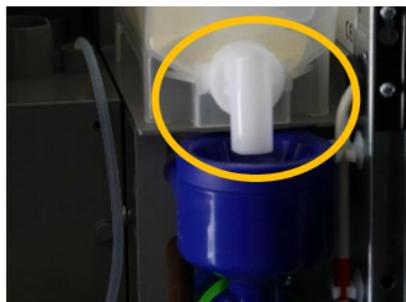
Prüfen Sie mit dem Finger den markierten Bereich auf Verschmutzung. Wenn nötig, drehen Sie den Milchausgabewinkel nach links und entnehmen Sie ihn zum Reinigen.
