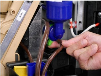
Drehen Sie den grünen Schieber nach rechts (gegen den Uhrzeigersinn) und entnehmen Sie den blauen Trichter.
