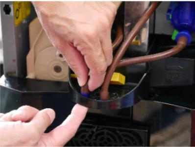
Entnehmen Sie die Schläuche aus dem schwarzen Zwischenboden. Durch leichtes Drücken von unten nachhelfen.
