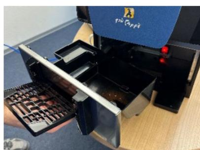
Leeren Sie die Tropfschale und den Satzbehälter. Setzen Sie anschließend beides wieder ein, bevor Sie mit der Reinigung fortfahren.
