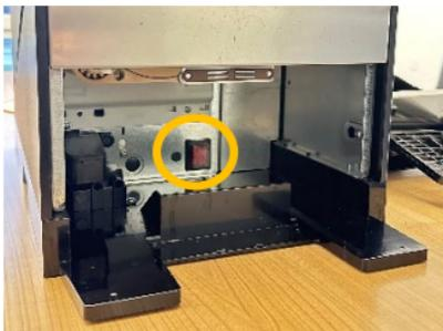
Legen Sie den roten Schalter um und nehmen Sie damit das Gerät in Betrieb. Anschließend sowohl Satzbehälter als auch Tropfschale wieder einsetzen.
