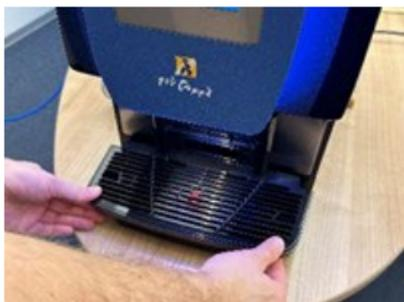
Entfernen Sie die Tropfschale und leeren Sie diese.
