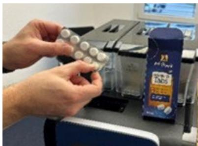
Öffnen Sie die schwarze Klappe. Legen Sie eine Tablette der più caffè Reinigungstabs in den Schacht.
