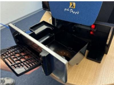
Ziehen Sie den Satzbehälter raus. Heben Sie dafür den Behälter leicht an.
