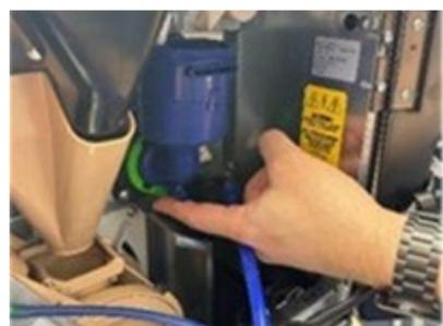
Entnehmen Sie den Mixerbecher und reinigen Sie die Einzelteile.
